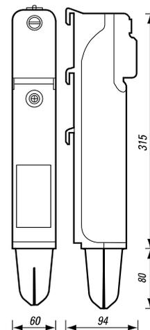
Kit borne de terre 16 mm<sup>2</sup>, livré monté sur rail DIN **900 504 10**
