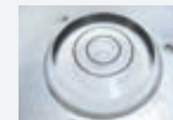
Réglage par niveau à bulle
